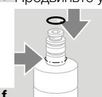
→ Если у прибора на месте, указанном стрелкой, имеется О-кольцо, замените привод описанным здесь способом: VAN 1: используйте все уплотнения из адаптерного комплекта для привода. VAN 2: используйте маленькое и только одно большое уплотнение из адаптерного комплекта для привода.
