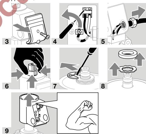
→ В зависимости от конструктивного исполнения прибора привод заменяется двумя различными способами: если у прибора на месте, указанном стрелкой, нет О-кольца, замените привод описанным здесь способом. В противном случае следуйте последующим указаниям.
