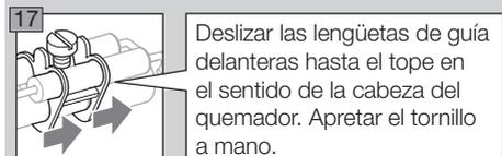
Deslizar las lengüetas de guía delanteras hasta el tope en el sentido de la cabeza del quemador. Apretar el tornillo a mano.
