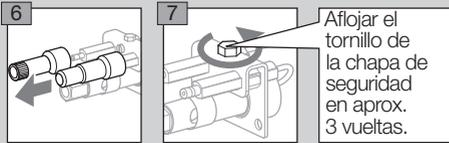
Aflojar el tornillo de la chapa de seguridad en aprox. 3 vueltas.
