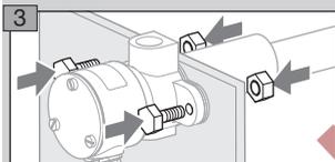
**4** Conectar la tubería del gas de encendido con Rp ¼ y la tubería del aire con Rp ½.
