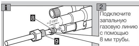
2 Подключите запальную газовую линию с помощью 8 мм трубы.
