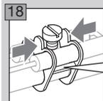
Продвигайте передние направляющие пластины до упора к головке горелки. Затяните винт вручную.
