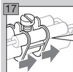
В более длинных горелках продвигайте следующие направляющие пластины до упора к крепежной пластине. Затяните винт вручную.
