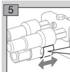
При поставке воздушная заслонка открыта. Закрывать воздушную заслонку можно только в случае нестабильного горения горелки.
