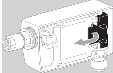
**5** Før ledningen gjennom M20-skruverbindingen.
