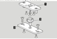
Per l'assemblaggio dell'IC 30 e della BVA, BVG. Set adattatore IC 30/BVA/BVG, numero d'ordine: 74924996.
