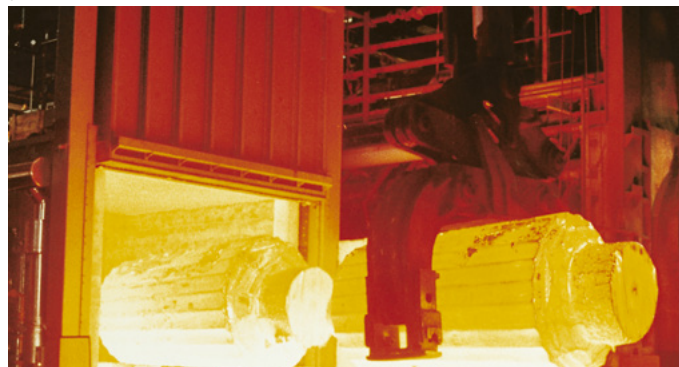
Four de forge à sole mobile dans l'industrie métallurgique
