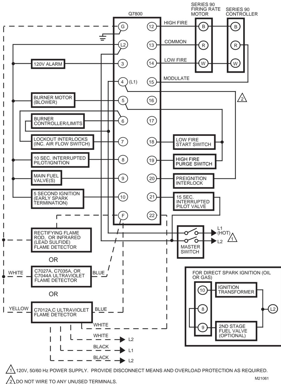
**Fig. 6. Wiring RM7800L Relay Module.**
