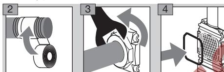
▷ O-ring ve süzgeç (Şekil 4) takılı olmalıdır.
