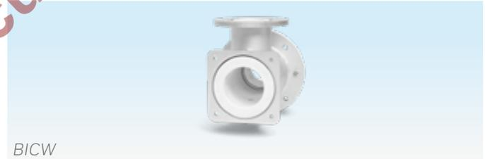
Die Brennergehäuse mit Isolierung können für höhere Warmlufttemperaturen bis 500 °C (932 °F) eingesetzt werden. Im Low-NO<sub>x</sub>-Betrieb menox ist die Warmlufttemperatur auf max. 450 °C (842 °F) beschränkt. Die Isolierung besteht aus vakuum-geformten Keramikfasern (RCF = refractory ceramic fibre) mit einer speziell gehärteten Oberfläche. Sie dient dazu, die Gehäusesoberflächentemperatur zu reduzieren.
