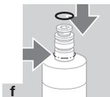
→ Si el presente dispositivo tiene una junta tórica en este punto (flecha), cambiar el actuador como aquí se describe: VAN 1: utilizar todas las juntas del set adaptador del actuador. VAN 2: utilizar la junta pequeña y solo una junta grande del set adaptador del actuador.
