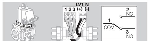
→ En caso de montaje de dos conectores en VAN con indicador de posición: marcar las bases de conector y los conectores para evitar que se intercambien.
