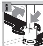
▷ Ao repetir a montagem, colocar a porca de fixação na posição inicial e, em seguida, apertar adicionalmente cerca de  $30^\circ$ .
