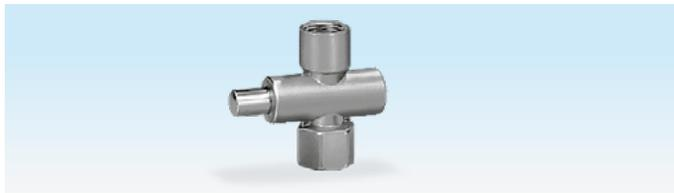
Der Druckknopfhahn DH dient als Absperrvorrichtung zwischen der Messleitung und dem Manometer. Das Manometer ist dadurch dauerhaft druckentlastet. Der Druckknopf wird betätigt, um das Manometer mit Druck zu beaufschlagen und den Betriebsdruck anzuzeigen.
