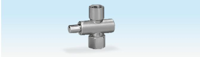
Le robinet de manomètre manuel DH sert de dispositif d'arrêt entre la ligne de mesure et le manomètre. Il permet une dépressurisation durable du manomètre. Le robinet est actionné pour mettre le manomètre en pression et afficher la pression de service.
