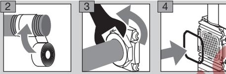
▷ O-Ring und Sieb (Bild 4) müssen eingebaut sein.
