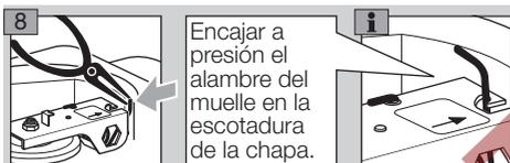
**i** Encajar a presión el alambre del muelle en la escotadura de la chapa.
