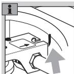
**18** Conectar la línea de impulsos y la tubería de aireación.
