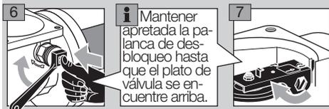
**i** Mantener apretada la palanca de desbloqueo hasta que el plato de válvula se encuentre arriba.
