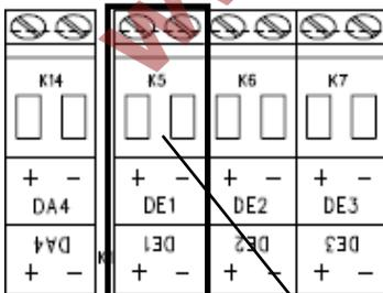
Der Impulsgeber oder Encoder des Gaszählers wird an die Klemme „DE1“ (1) des EK280 angeschlossen.
