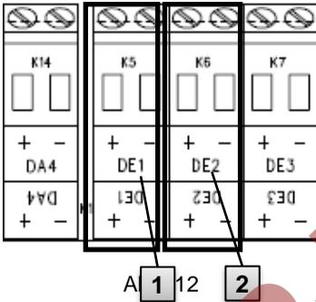
1. Schließen Sie den niederfrequenten Impulsgeber des Gaszählers an die Klemme „DE1“ (1) des EK280 an.
