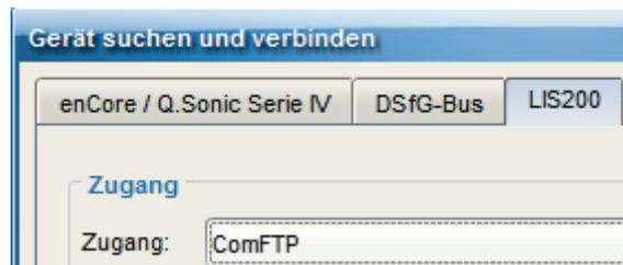
**Hinweis:** Dadurch wird die Baudrate für eine lokale serielle RS232-Verbindung automatisch auf 9600 Baud reduziert.
