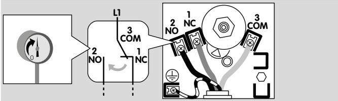
Die Kontakte 3 und 2 schließen bei steigendem Druck.
