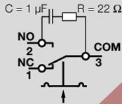
Bei hoher Luftfeuchtigkeit oder aggressiven Gasbestandteilen ( $\text{H}_2\text{S}$ ) empfehlen wir einen Druckwächter mit Goldkontakt aufgrund der höheren Korrosionsbeständigkeit. Eine Ruhestromüberwachung ist unter schwierigen Einsatzbedingungen empfehlenswert.
