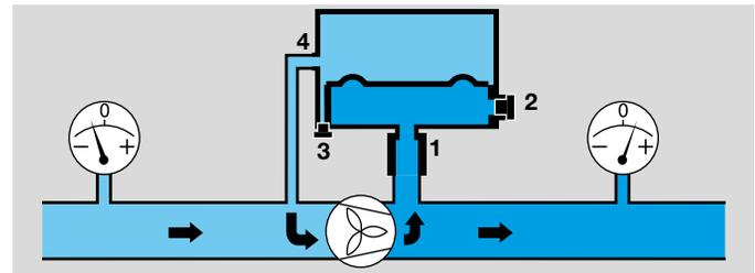
Der höhere Absolutdruck wird an **1** (oder **2**) und der niedrigere Absolutdruck **4** (oder **3**) angeschlossen. Die frei bleibenden Anschlüsse müssen dicht gesetzt werden.
