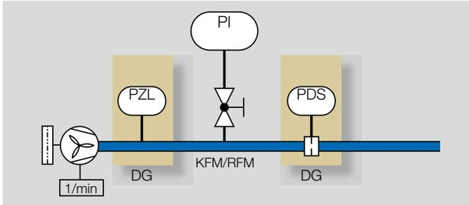
Die vom Ventilator erzeugte Luftströmung darf wie folgt überwacht werden:
