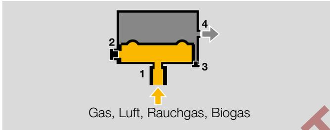
Der Überdruck wird über den Membranunterraum, Anschluss **1** (oder **2**), gemessen. Der Membranoberraum wird über den Anschluss **4** (oder **3**) belüftet.
