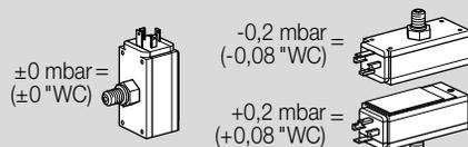
Einbaulage senkrecht oder waagrecht. Bei waagerechter Einbaulage ändert sich der voreingestellte Schalterpunkt um 0,2 mbar (0,08 °WC). Wird der DG..C mit Stecker nach unten zeigend eingebaut, reduziert sich die Schutzart auf IP 40, siehe Seite 17 (Einstellbereich, Schalthysterese).
