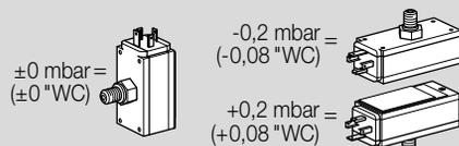
Posición de montaje vertical u horizontal. En la posición de montaje horizontal se modifica el punto de actuación preajustado en 0,2 mbar (0,08 pulgadas CA). Al instalar el DG..C con el conector hacia abajo, el grado de protección se reduce a IP 40, ver página 17 (Rango de ajuste, histéresis de conmutación).
