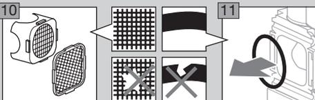
**12** После замены уплотнительных прокладок вставьте сетчатый фильтр и дроссельную вставку на место и монтируйте многофункциональное устройство в трубопровод.
