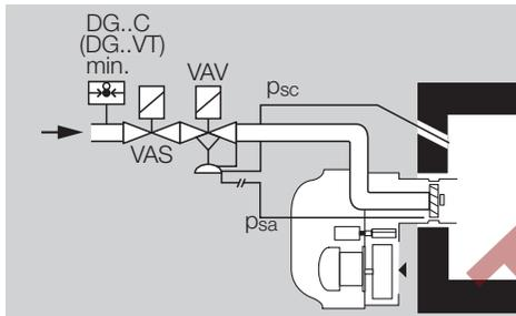
▷ VAV..K: 2 резьбовых соединения для пластмассовой трубки (внутренний  $\varnothing$  3,9 мм (0,15"); внешний  $\varnothing$  6,1 мм (0,24")).
