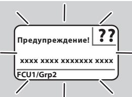
**?** Подсветка мигает и на дисплее отображаются сообщения «Задиное отключение!», «Отключение с аварийной блокировкой!», «Предупреждение!» или «Ошибка прибора!», содержащие соответствующий текст и код ошибки.
