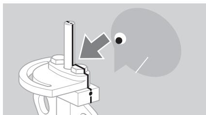
▷ Монтажное положение: вертикальное или горизонтальное, не вниз приводом.
