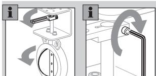
**9** Дисковый затвор снова закройте. Проверьте, соответствует ли положение затвора отметке!
