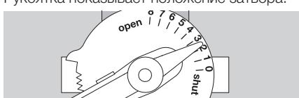
Рукоятка находится под углом 90° к оси трубопровода = затвор закрыт (shut).
