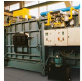
*Regulador de proporción en horno de fusión para asegurar una combustión estequiométrica en toda la gama de potencia*
