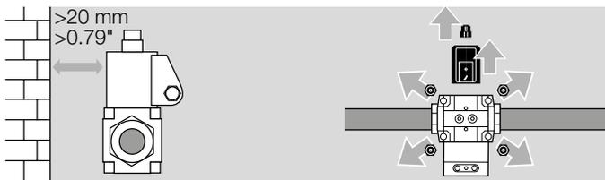
Das Gerät darf kein Mauerwerk berühren. Mindestabstand 20 mm (0,79 inch).
