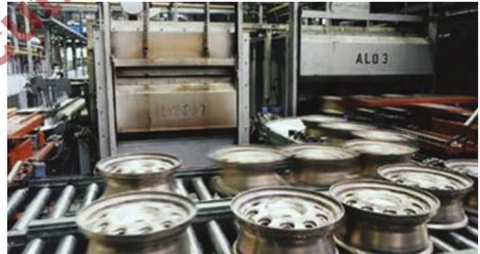
Aluminium-Aushärteofen mit Gleichdruckreglern zur Luftmangelsicherung
