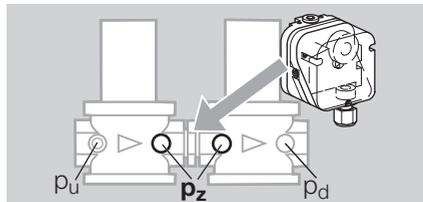
▷ Na VG 15 – 40/32, a conexão de medida está conectada com a entrada da válvula.
