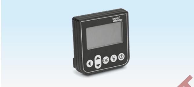
Die OCU ist eine externe Bedieneinheit, die an ein Steuergerät der FCU 500-/BCU 500-Serie angeschlossen werden kann. Die externe Bedieneinheit OCU wird in die Tür eines Schaltschranks eingebaut. Dadurch muss der Schaltschrank nicht geöffnet werden, um Prozesswerte, Statistiken, Flammensignalstärken oder Parameterwerte auszulesen, Einstellungen an der OCU zu ändern oder angeschlossene Klappen im Handbetrieb anzusteuern und zu justieren.
