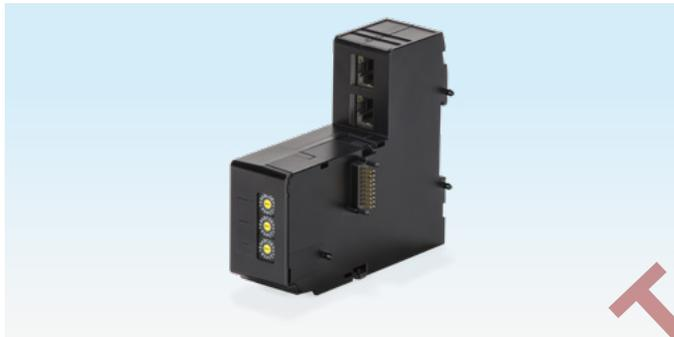
Das Busmodul BCM 500 dient als Kommunikationsschnittstelle für die Geräte der Produktfamilie BCU/FCU 500 zur Anbindung an eine Feldbuskommunikation (Profinet oder Modbus TCP). Durch die Vernetzung über Feldbus kann die FCU oder BCU von einem Automatisierungssystem (z. B. SPS) gesteuert und überwacht werden.
