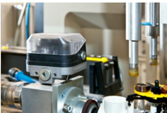
Le contrôle de la dépression permet de s'assurer que les composants sont correctement placés lors du montage entièrement automatisé des compteurs de gaz.
