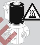
Der Magnetantrieb wird beim Betrieb heiß. Oberflächentemperatur ca. 85 °C (ca. 185 °F) nach EN 60730-1 bei 10 % Überspannung und 25 °C (77 °F) Umgebungstemperatur.
