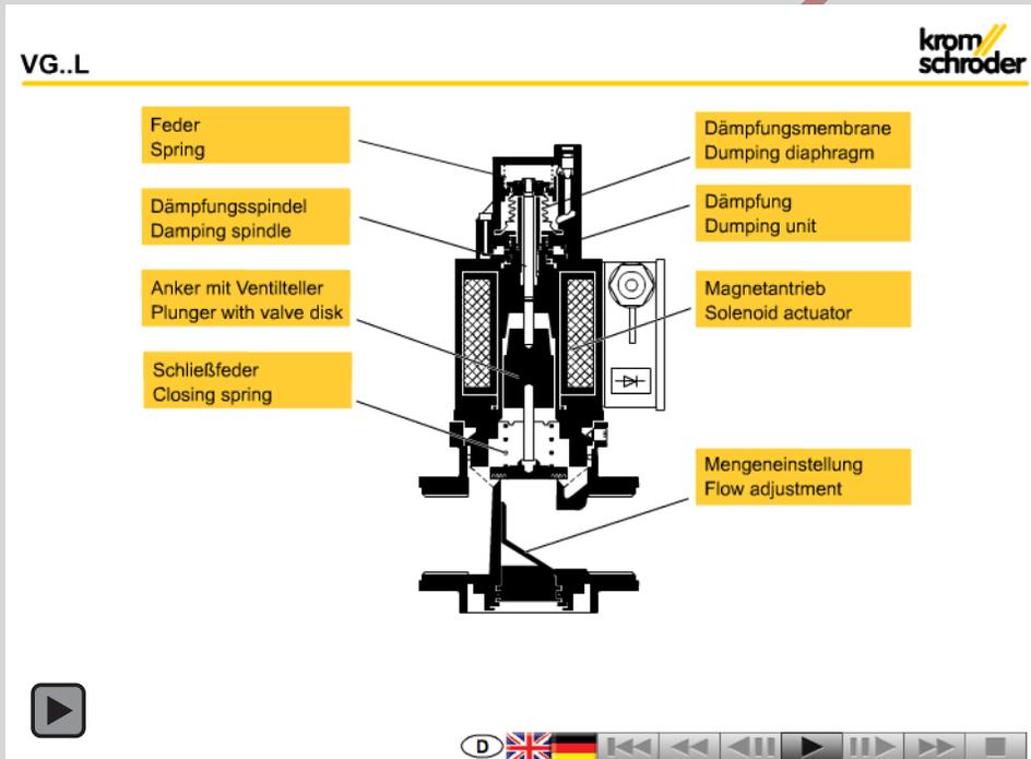
Die Animation zeigt interaktiv die Funktion des Gas-Magnetventils VG.. L, langsam öffnend.
