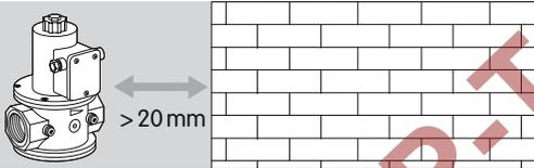
Das Gas-Magnetventil VG darf kein Mauerwerk berühren. Mindestabstand 20 mm.
