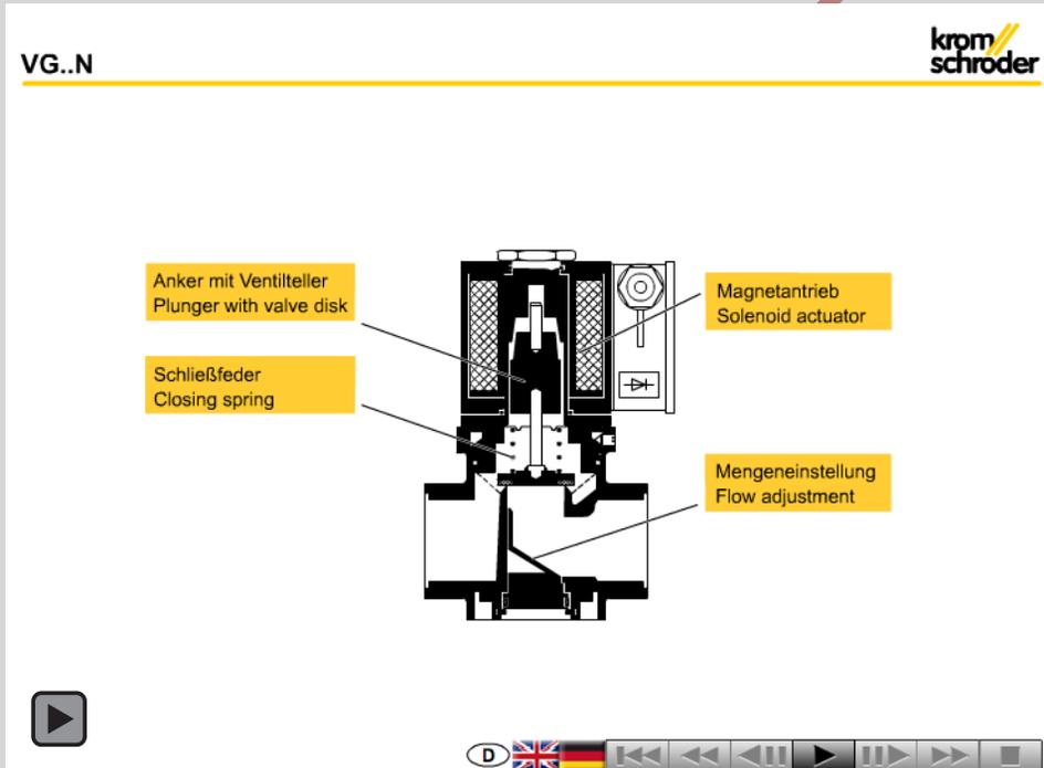
Die Animation zeigt interaktiv die Funktion des Gas-Magnetventils VG..N, schnell öffnend.
