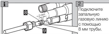
**2** Подключите запальную газовую линию с помощью 8 мм трубы.
