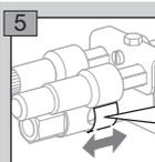
При поставке воздушная заслонка открыта. Закрывать воздушную заслонку можно только в случае нестабильного горения горелки.
