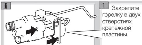
**1** Закрепите горелку в двух отверстиях крепежной пластины.
