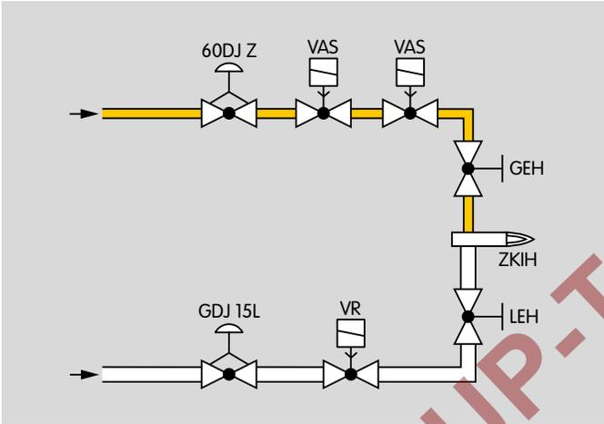
Le mélange air-gaz est réglé via le robinet de réglage du débit de gaz GEH et le robinet de réglage du débit d'air LEH. Un régulateur de pression par brûleur est installé côtés gaz et air pour assurer un mélange air-gaz constant ( $\lambda$ ).
