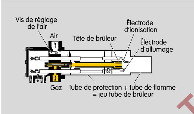
Les éléments de réglage de l'air et du gaz sont ouverts par la commande de brûleur. Le gaz afflue via le raccord gaz et l'air via le raccord d'air dans le corps du brûleur jusqu'à la tête de brûleur.
