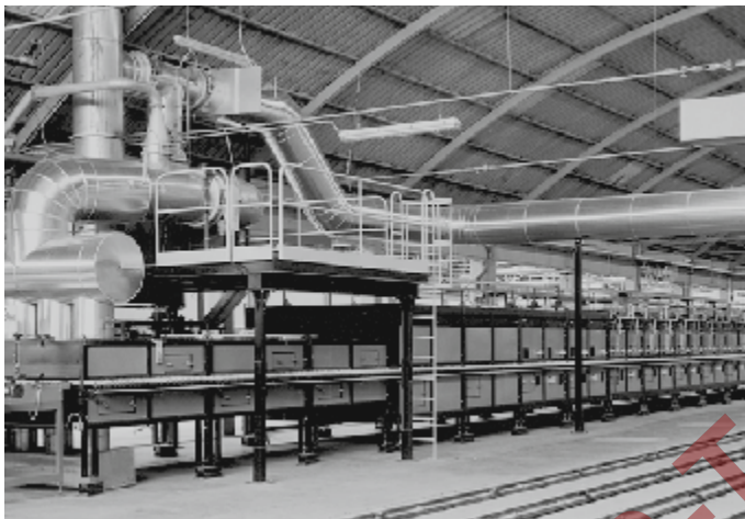
Four à rouleaux dans l'industrie de la céramique
