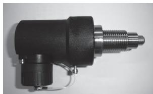
Für höhere Frequenzbereiche können Sie **HF-Impulsgeber** Typen A1R und A1S (falls vorhanden) verwenden. HF-Impulsgeber sind im Zählergehäuse druckfest eingeschraubt. Der Anschlussstecker ist jedoch drehbar.
