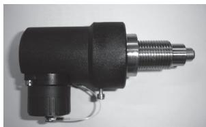
Pour des gammes de fréquence plus élevées, vous pouvez utiliser des **émetteurs d'impulsions haute fréquence** types A1R et A1S (si disponibles). Les émetteurs d'impulsions haute fréquence sont vissés à l'épreuve de la pression dans le corps du compteur. Le connecteur de raccordement peut cependant être tourné.
