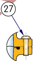
PARAFUSO PARA FIXAÇÃO DO CORPO DA VÁLVULA
