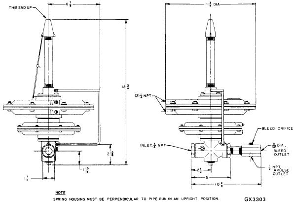
SPRING HOUSING MUST BE PERPENDICULAR TO PIPE RUN IN AN UPRIGHT POSITION. PIPE RUN MUST BE LEVEL.
