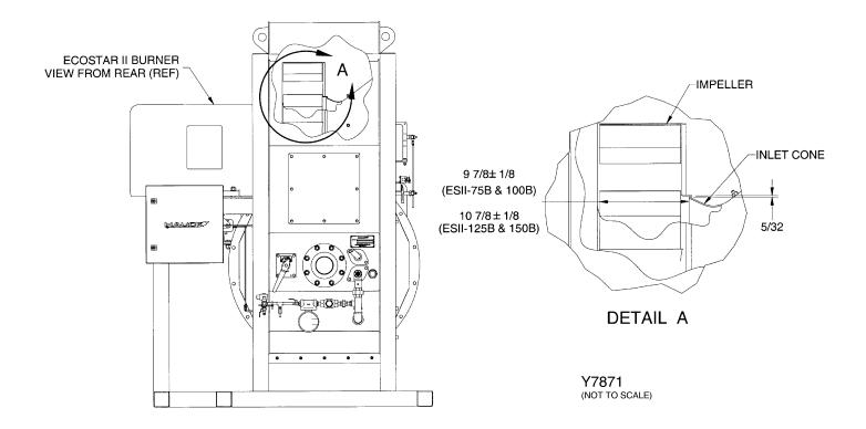
Figure 26. Proper Impeller Position On Motor Shaft
