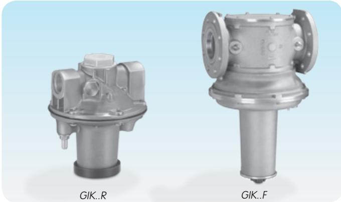
Die Gas-Gleichdruckregler GIK mit Vordruckausgleichsmembrane und Nullabschluss dienen zum Konstanthalten des Gas-Luft-Verhältnisses und der Gasdruckregelung vor Gasbrennern an Anlagen ohne vorgewärmte Verbrennungsluft.
