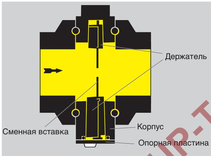
Держатель со сменной вставкой располагается в корпусе VMO. Газ проходит через отверстие в данной вставке. Замена сменной вставки осуществляется вместе с держателем путем снятия опорной пластины с корпуса.
