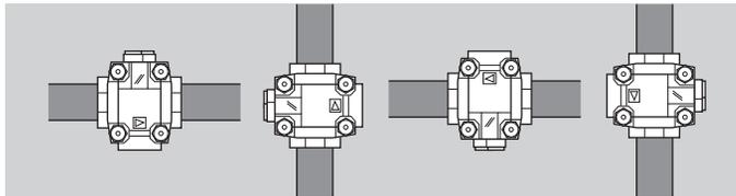
Монтажное положение: VMO может быть установлена в любом положении.
