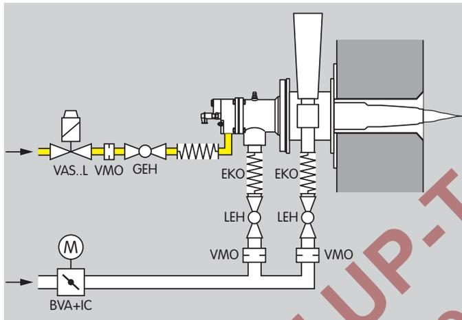
Рекуперативная горелка в системах с прямым нагревом снабжена эжектором для удаления дымовых газов из печи. Эжектор удаляет дымовые газы из печного пространства через рекуператор горелки.
