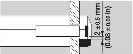
20 A forno freddo controllare il tubo ceramico attraverso la flangia del forno.
