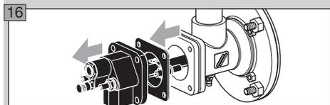
▷ Quando si smonta l'inserto del bruciatore, si deve subito cambiare la guarnizione della flangia di attacco.
