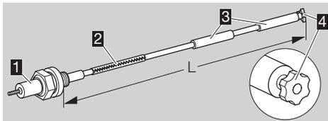
8 Se la stella **4** o l'isolatore **3** risultano danneggiati, sostituire l'elettrodo.
