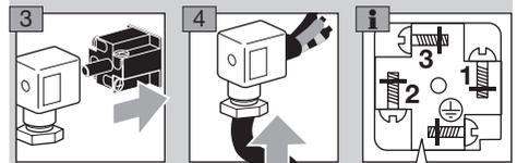
Steckdose nach Anschlussbild des dazugehörigen Gasfeuerungsautomaten, Flammenwächters oder der Brennersteuerung verdrahten, einschließlich Schutzleiter.
