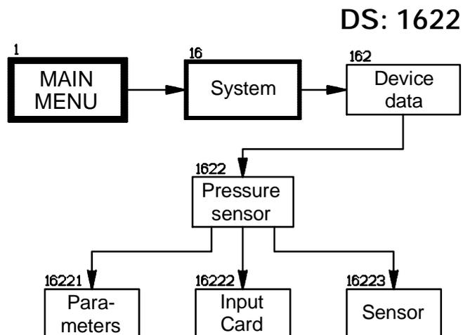
**Fig. 3.4.6-6:** Pressure sensor
