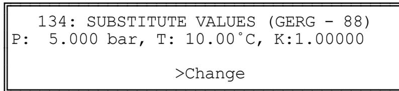
Fig. 3.4.3-6: Menu: Substitute values (user lock open)
