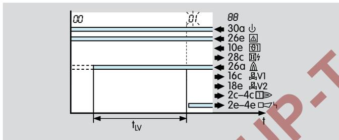
Если PFU сообщает о таком постороннем сигнале в течение проверки на источник постороннего излучения, то начинается время задержки постороннего пламени  $t_{LV}$  (25 с). Если посторонний сигнал прекращается в течение этого периода, горелка может быть запущена. Иначе происходит аварийное отключение. На дисплее мигает [1], если источник постороннего излучения обнаружен от пилотной горелки, если от основной горелки – мигает [5].
