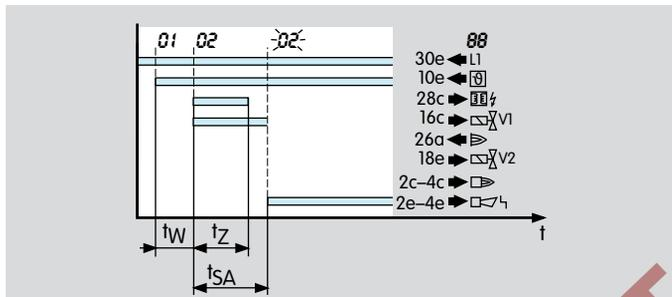
Как только поступает сигнал запуска ( $\vartheta$ ), начинает протекать время ожидания  $t_W$ . В этот период проводится самотестирование на обнаружение неисправностей внутренних и внешних компонентов системы безопасности. Если в течение этого периода неисправностей не обнаружено, горелка запускается.
