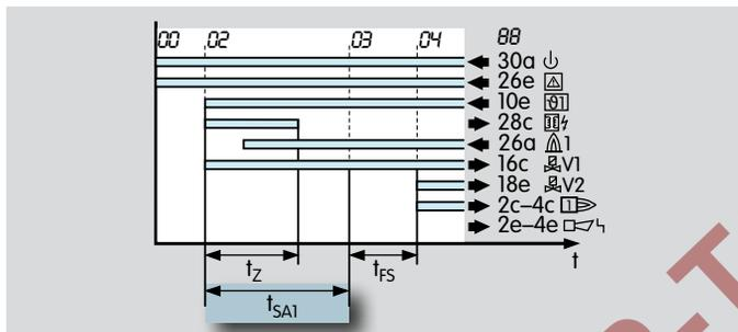
Время безопасности  $t_{SA1}$  для пилотной горелки при запуске.
