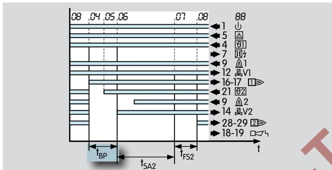
Время паузы оказывает влияние на характер работы только основной горелки. Примечание: Пилотная горелка используется только при одноступенчатом управлении.
