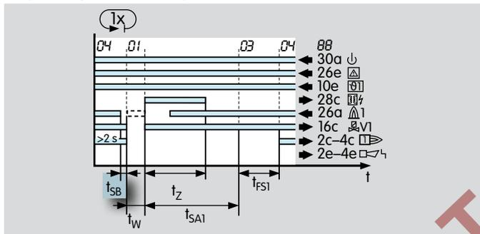
Если PFU обнаруживает пропадание пламени через минимум 2 с работы, клапаны закрываются, и контакт управляющего сигнала размыкается по истечении времени  $t_{SB}$ .
