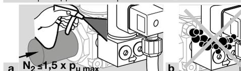
Проверьте герметичность байпасного клапана/газового клапана запальной горелки на входе и выходе.
