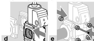
→ Соблюдайте рекомендуемый момент затяжки на соединительных элементах! См. стр. 15 (12.2.1 Момент затяжки).
