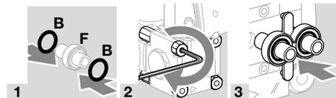
**4** Снимите заглушку с монтажной стороны байпасного клапана.
