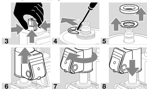
→ Выдавите в обоих клеммных боксах заглушку под комплект кабельного ввода – и только после этого снимайте крышки с клеммных боксов, чтобы предотвратить поломку язычков.
