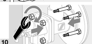
→ Avvitare l'inserto del bruciatore in croce: BIC(A) 50-100 con max 15 Nm (11 lb ft), BIC 125-140 con max 30 Nm (22 lb ft).
