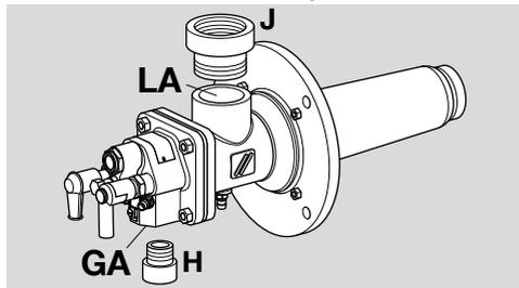
→ **BIC 125, BIC 140, BICW:** saldare la flangia **K** per il raccordo aria **LA** al tubo aria **P** e utilizzare l'adattatore con filettatura NPT **H** per il raccordo gas **GA**.
