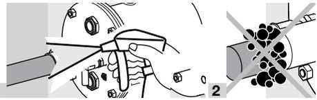
→ Kondensatbildung durch eindringende Ofenatmosphäre im Brennergehäuse verhindern. Bei Ofentemperaturen über 500 °C (932 °F) den abgeschalteten Brenner ständig mit einer geringen Luftmenge kühlen – siehe Seite 9 (6.6 Kühlluft).
