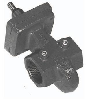
Las válvulas de cierre normalmente cerradas utilizan energía eléctrica para abrirse. La eliminación de la señal eléctrica permite la liberación instantánea del mecanismo de retención, permitiendo que el potente muelle de cierre, cierre la válvula en menos de un segundo.
