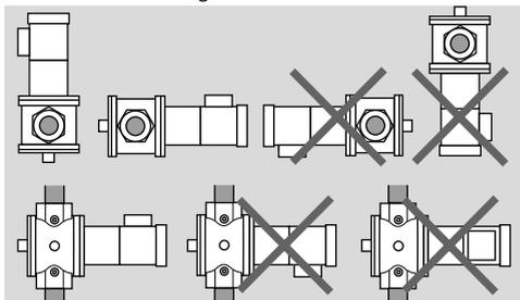
→ La vanne motorisée gaz VK ne doit pas être en contact avec une paroi. Écart minimal de 20 mm vers le côté.
