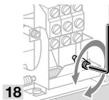
18 → Tourner la vis à l'aide d'une clé mâle à six pans jusqu'à ce que, la course désirée atteinte, l'interrupteur commute :
