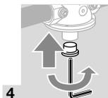
Réglage du débit de démarrage dans le cas de la vanne VK..Z..S et l'indicateur de position dans le cas de la vanne VK..S ou VK..Z..S
