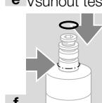
→ Má-li daný přístroj O-kroužek na tomto místě (šipka), pak se pohon vymění dle popisu: VAN 1: použít všechna těsnění ze sady adaptérů pohonu. VAN 2: použít malé těsnění a jen jedno velké těsnění ze sady adaptérů pohonu.
