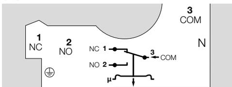
In caso di campo di regolazione positivo, rimuovere lo schema situato nell'apparecchio e collegare i cavi secondo lo schema di collegamento stampato.
