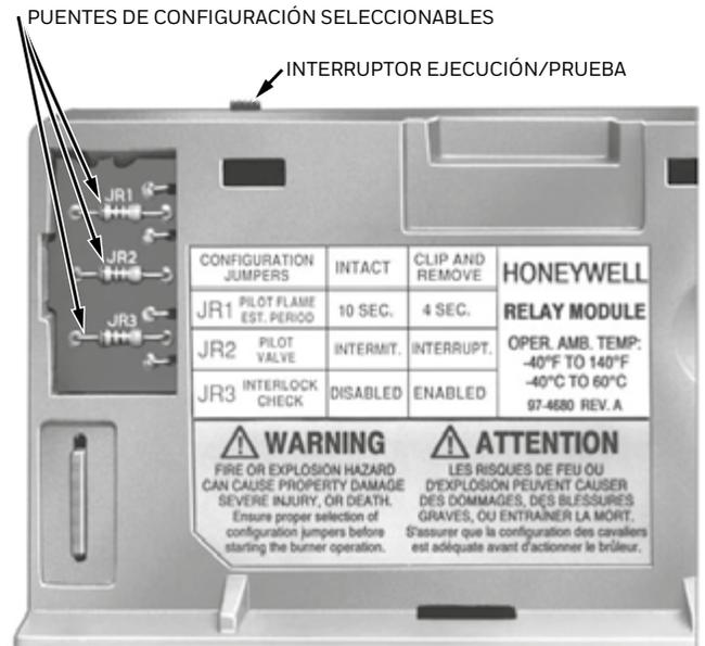
NOTA: SE MUESTRAN LOS PUNTES DE CONFIGURACIÓN PARA LOS MODELOS RM7800G/7840G
